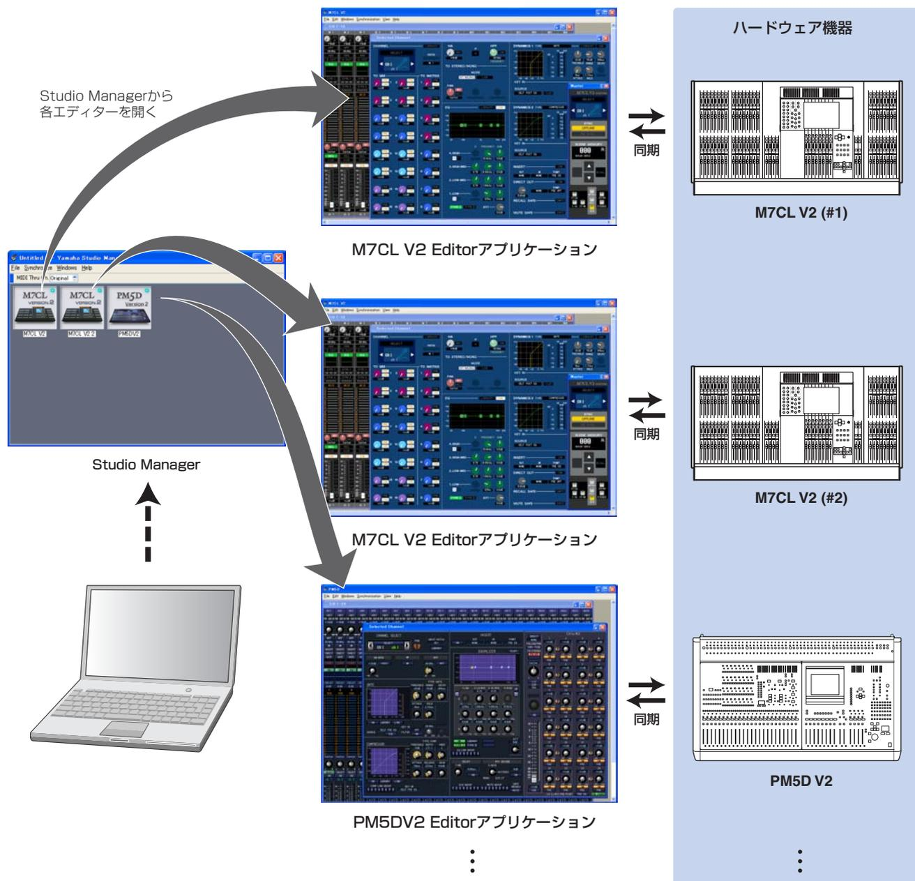
各エディターの設定は、Studio Managerでまとめて保存/呼び出しできます。すなわち、複数の機器の設定をStudio Managerからまとめて呼び出す(リコール)ことにより、システム全体の設定を簡単な操作で変更できます。また、設定ファイルを保存する場合、Studio Managerから操作すれば複数の機器をまとめてリコール、各エディターで操作すればその機器だけをリコール、と使い分けることもできます。
